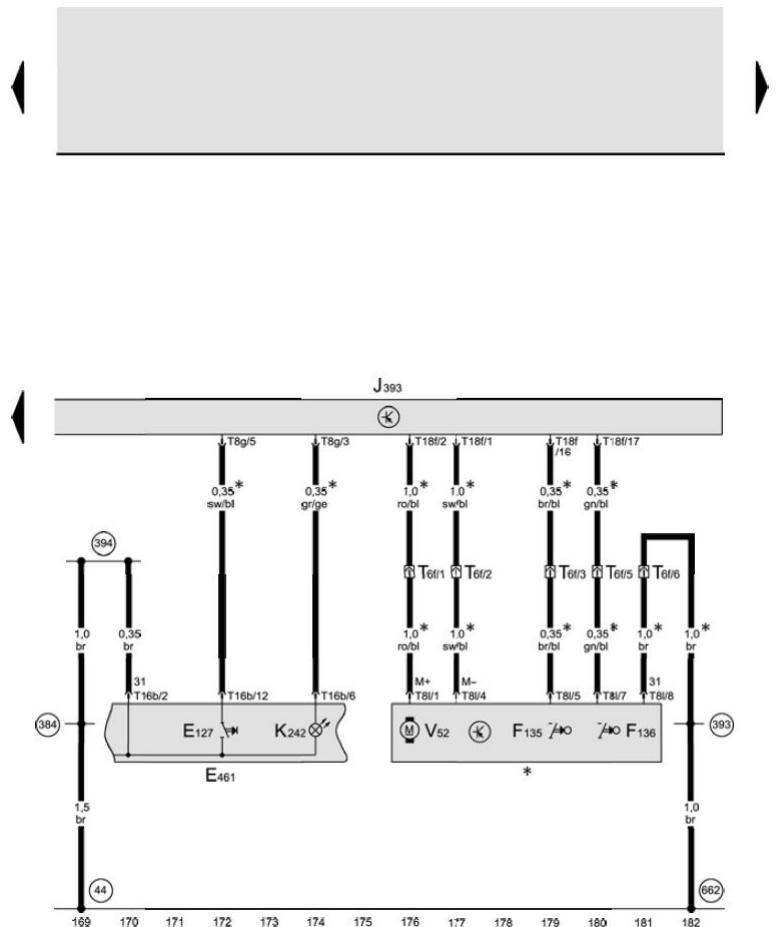
便捷功能系统中央控制器, 尾部导流板调节开关, 尾部导流板调节指示灯, 尾部导流板调节马达
