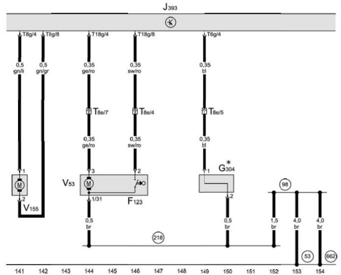
舒适/便捷功能系统中央控制器、油箱盖锁闭马达、行李箱盖内防盗报警装置的接触开关、后盖中中央门锁马达、后窗玻璃破碎传感器
