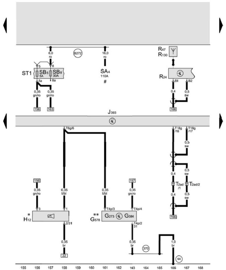
舒适 / 便捷功能系统中央控制器，报警喇叭，防盗装置传感器，天线放大器
