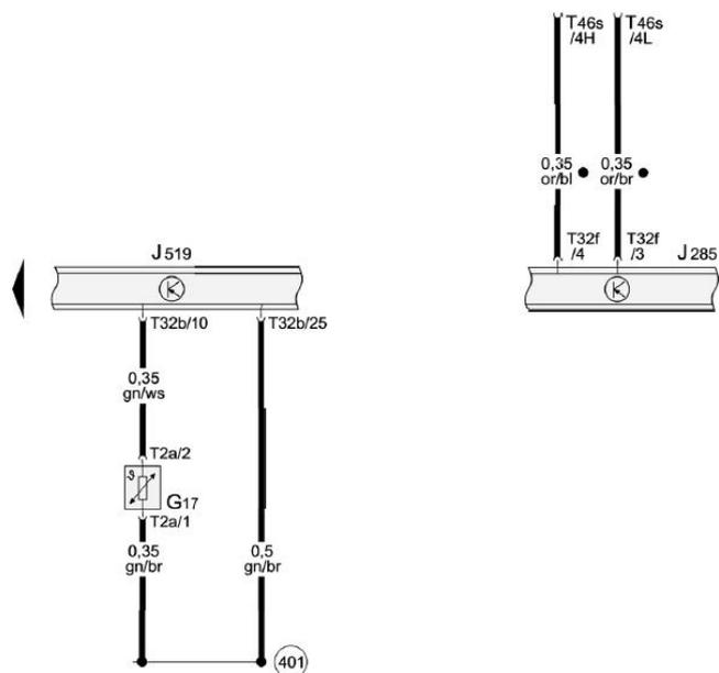
外界温度感应器、车载电网控制器、组合仪表中的控制器
