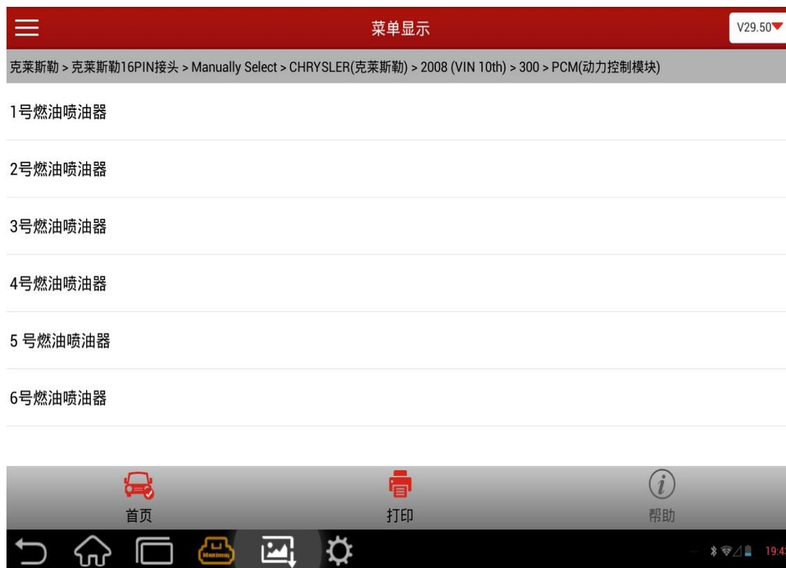
3). 点击“确定”后弹出菜单列表，显示 1 号燃油喷油嘴 - n 号燃油喷油嘴（n 根据实际车辆的缸数决定）的菜单。
