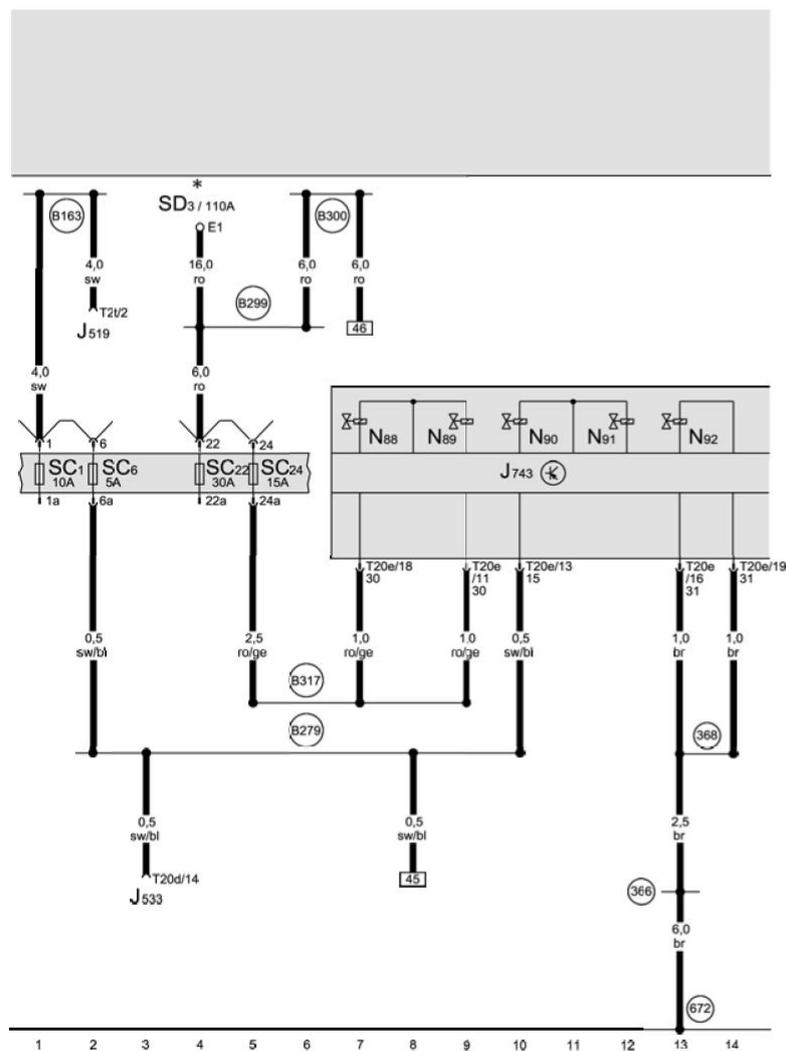
双离合变速器机电装置，电磁阀，保险丝
