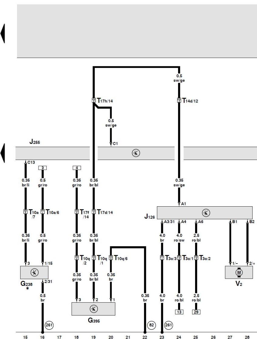
**Climatronic** 控制单元、空气质量传感器、制冷剂压力和制冷剂温度传感器、新鲜空气鼓风机控制单元、新鲜空气鼓风机
