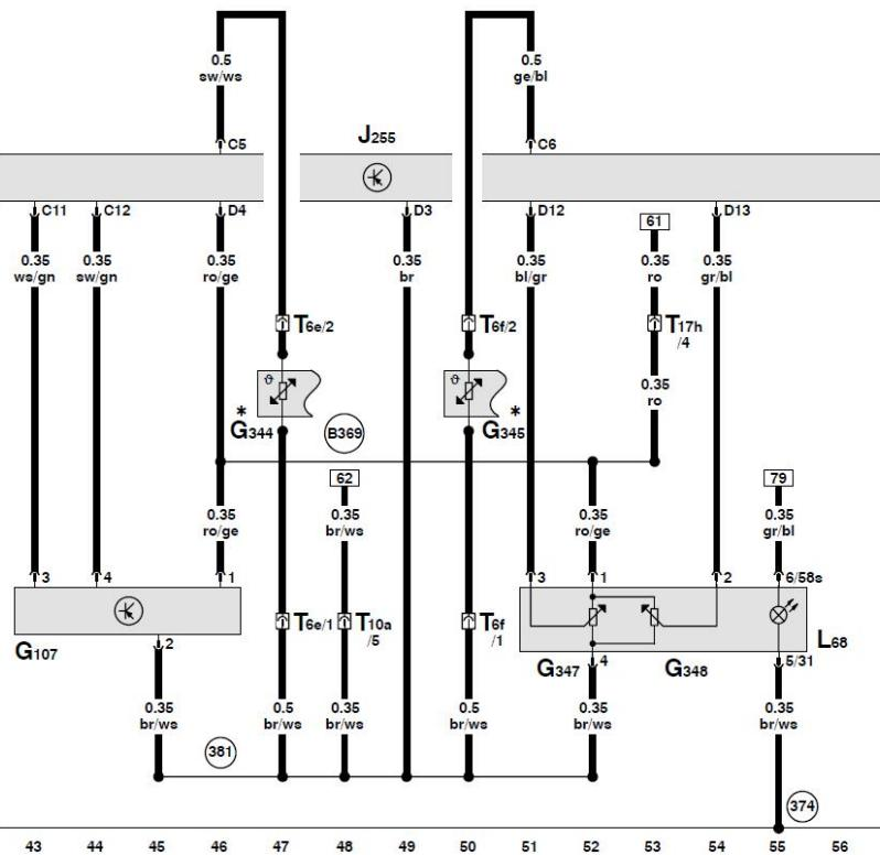
**Climatronic** 控制单元、左侧和右侧中部出风口传感器、左前和右前座椅温度传感器、日照光电传感器
