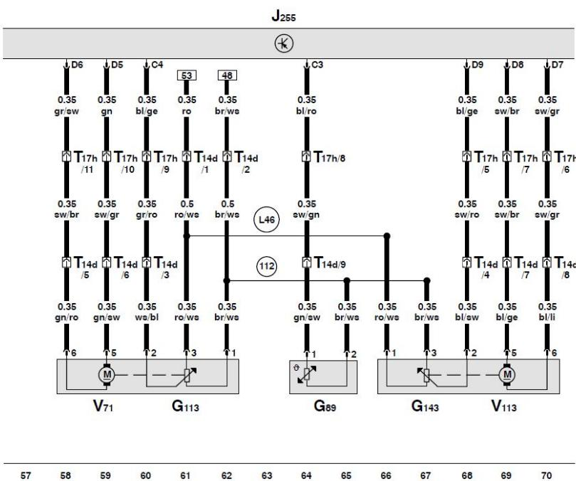
**Climatronic 控制单元、速滞压力风门的伺服马达、空气内循环风门的伺服马达、新鲜空气进气道温度传感器**
