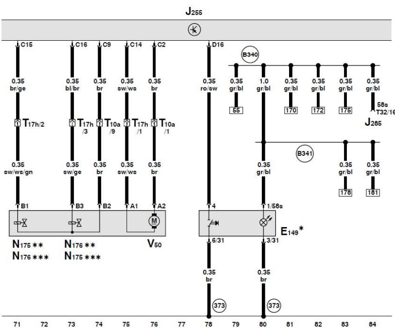
**Climatronic 控制单元、冷却液循环泵、左侧和右侧暖风调节阀门、后窗遮阳帘开关**
