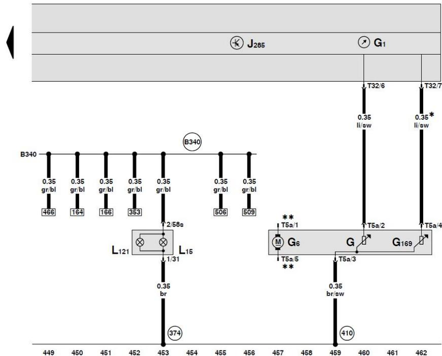
组合仪表中带显示单元的控制单元、燃油储备显示、燃油存量传感器 2、烟灰缸照明灯泡、饮具托架照明
