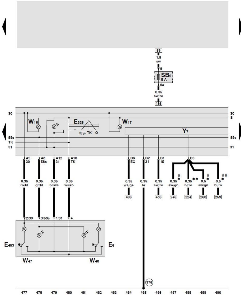
后部车内照明灯开关、左后和右后车内照明灯、自动防眩的车内后视镜
