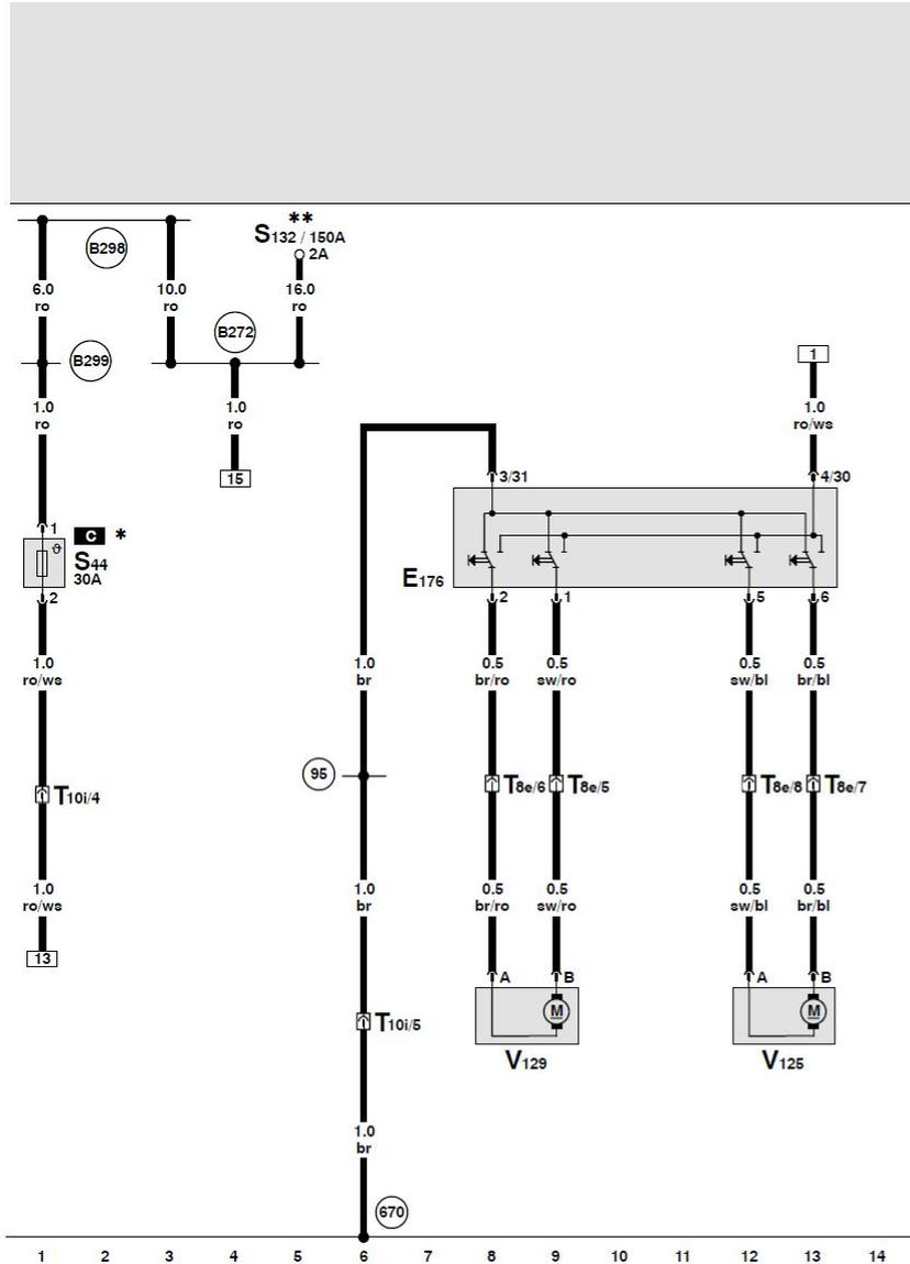
驾驶员座椅腰部支撑调节开关、驾驶员座椅腰部支撑前后位置调整马达、驾驶员座椅腰部支撑高度调整马达
