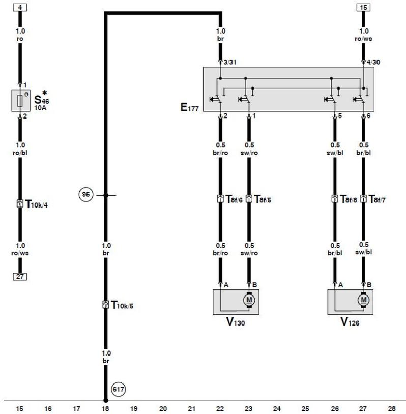
副驾驶员座椅腰部支撑调整开关、副驾驶员座椅腰部支撑前后位置调整马达、副驾驶员座椅腰部支撑高度调整马达
