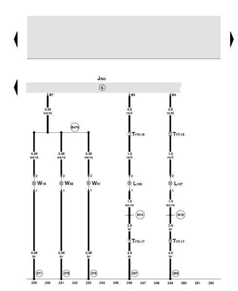
舒适系统中央控制单元、行李箱照明灯、尾门灯、后脚 部空间照明灯
