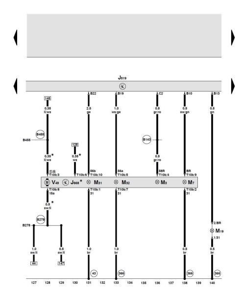
车载电网控制单元、右侧大灯计算机处理模块、右侧停车灯灯泡、右前转向信号灯灯泡、右侧面转向信号灯灯 泡灯泡、右侧近光灯灯泡、右侧远光灯灯泡、右侧大灯 光线水平调整伺服马达
