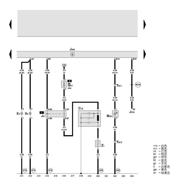
舒适系统中央控制单元、牌照灯、可加热后窗玻璃、高 位刹车灯灯泡
