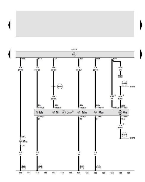
车载电网控制单元、左侧大灯计算机处理模块、左侧停车灯灯泡、左前转向信号灯灯泡、左侧面转向信号灯灯 泡、左侧近光灯灯泡、左侧远光灯灯泡、左侧大灯光线水平调整伺服马达
