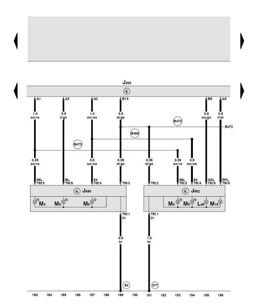
舒适系统中央控制单元、左尾灯灯泡、左后转向信号灯 灯泡、左刹车灯灯泡、左倒车灯灯泡、左后雾灯灯泡
