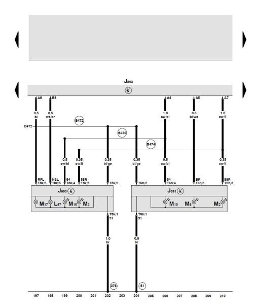
舒适系统中央控制单元、右尾灯灯泡、右刹车灯灯泡、 右后转向信号灯灯泡、右倒车灯灯泡、右后雾灯灯泡
