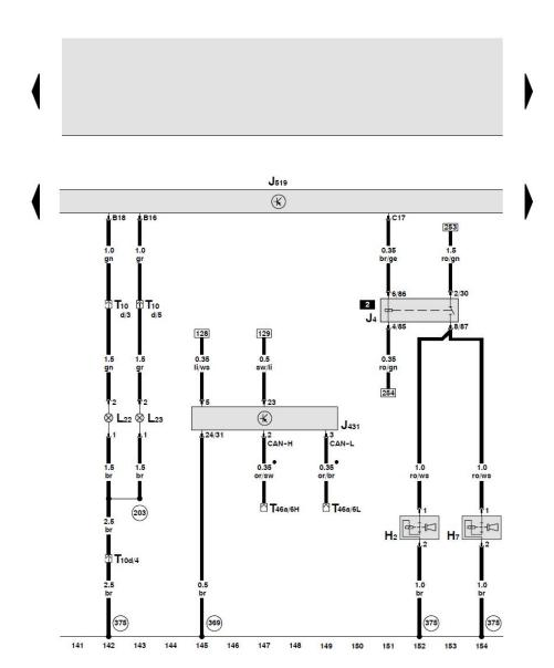
车载电网控制单元、左右前雾灯灯泡、大灯光线水平调 整控制单元、高音喇叭、低音喇叭
