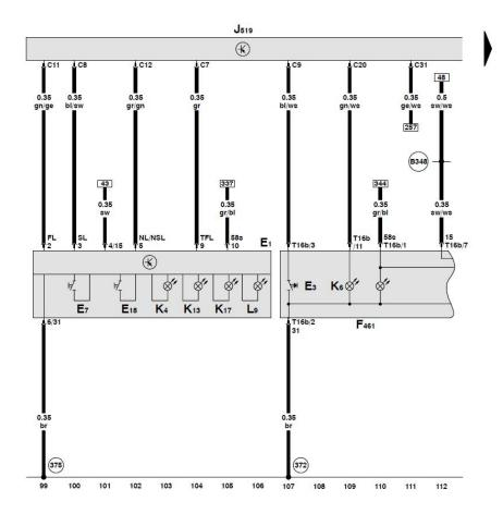
车载电网控制单元、车灯开关、闪烁报警灯开关、中控 台开关区
