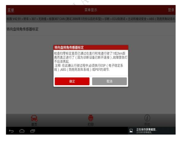
B). 若如下图显示,则需将故障码清除后,再执行一遍该功能:
