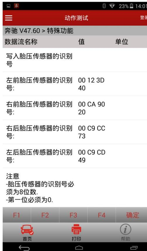
6). 点击确定，提示如下图所示，可以看到，输入的传感器 ID 显示在第一行。
