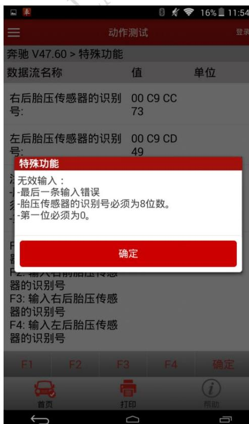
5). 点击确定，返回到输入框界面。输入正确的传感器 ID，返回到界面
