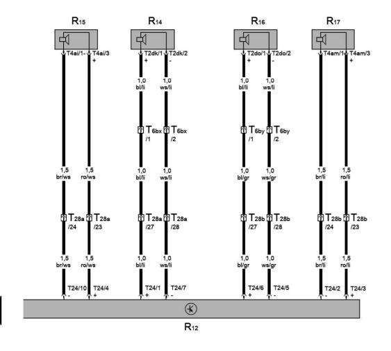
T2dk 2 芯插头连接 T2do 2 芯插头连接 T4ai 4 芯插头连接 T4am 4 芯插头连接 T6bx 6 芯插头连接,在左后车门中 T6by 6 芯插头连接,在右后车门中 T24 24 芯插头连接 T28a 28 芯插头连接,左侧 B 柱连接位置 T28b 28 芯插头连接,右侧 B 柱连接位置
