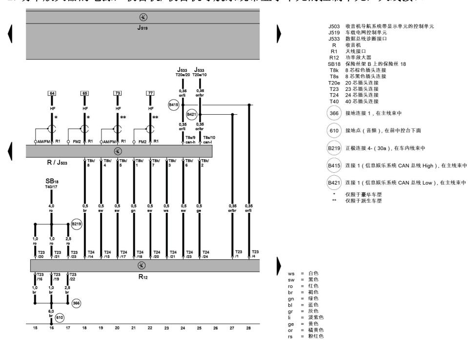
3. 左前高音喇叭,左前中音喇叭,左前低音喇叭,右前高音喇叭,右前中音喇叭,右前低音喇叭,功率放大器
