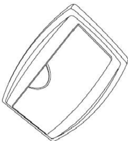
后阅读灯总成位于车顶内饰板后部的中心位置上。总成被固定在顶蓬上，小心地将总成撬起就可以从顶蓬上拆下。整个装置用3针脚（低配）或4针脚（高配）连接器将总成与车顶线束连接。
