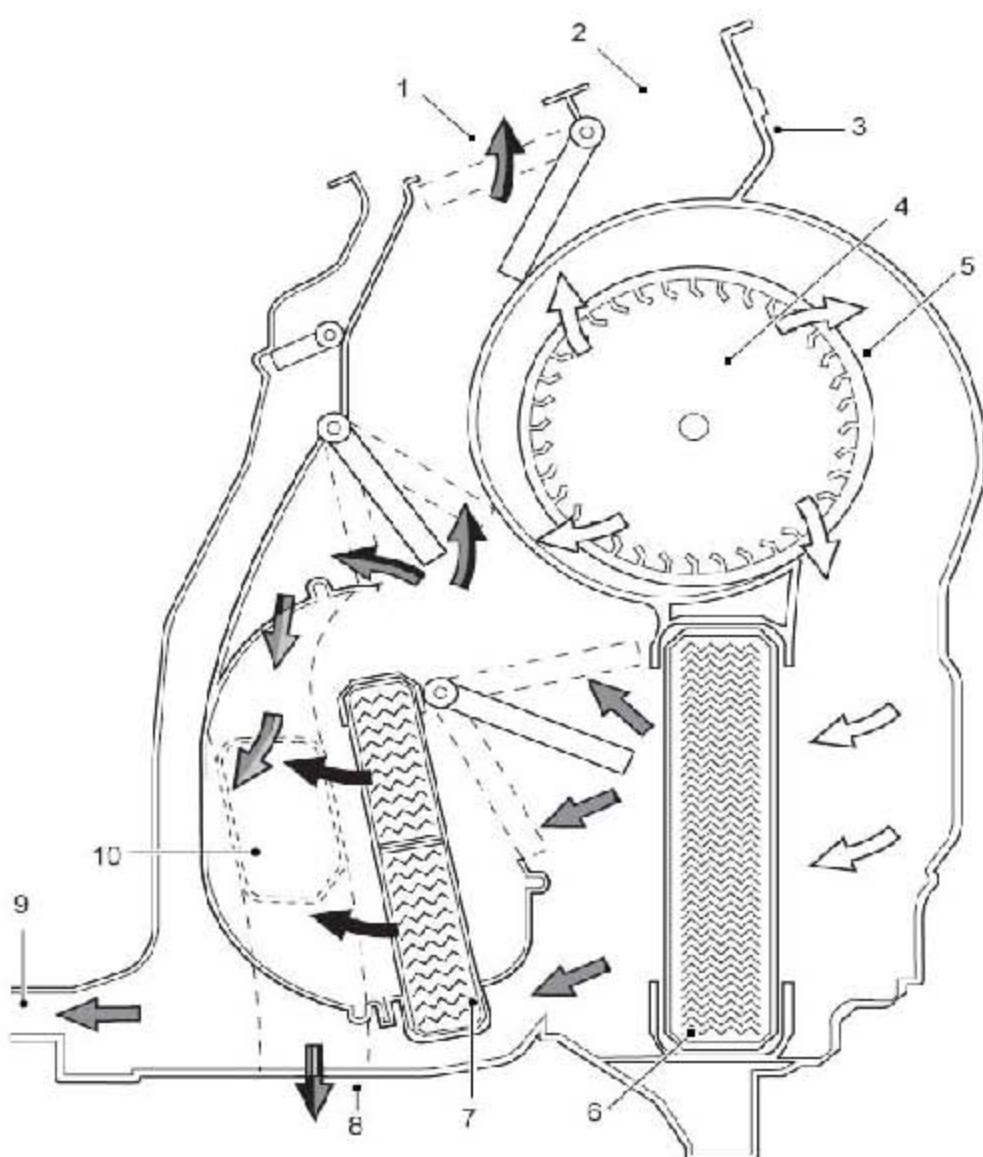
图上显示了至前座面部和脚部位置出风口的中等热量的风门位置
