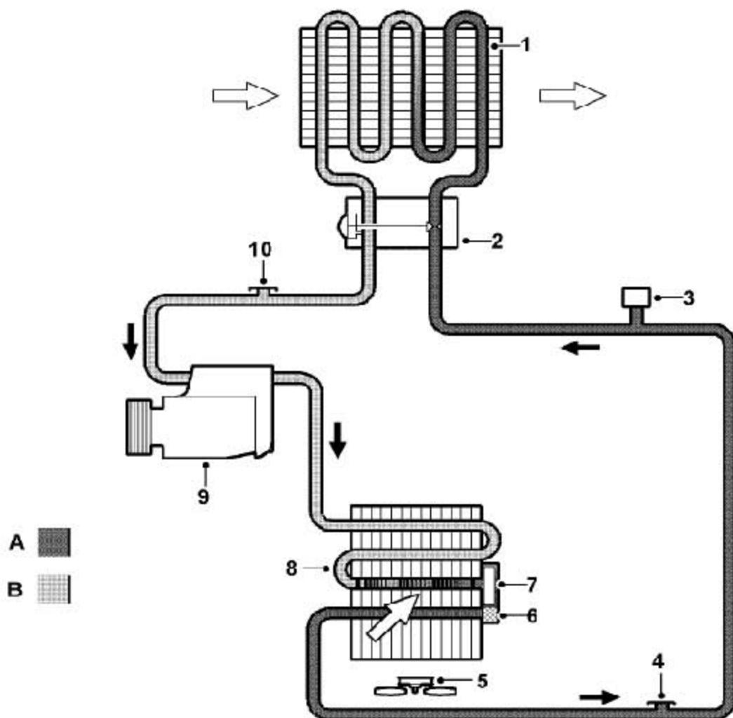
A= 液态制冷剂; B= 气态制冷剂
