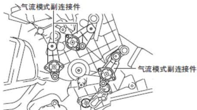
2). 如图所示将气流模式主连接件固定在A/C装置上。
