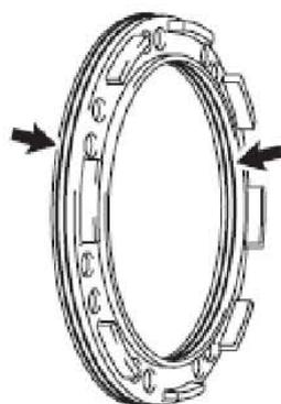
B). 将2号制动器活塞安装到变速器壳上。
