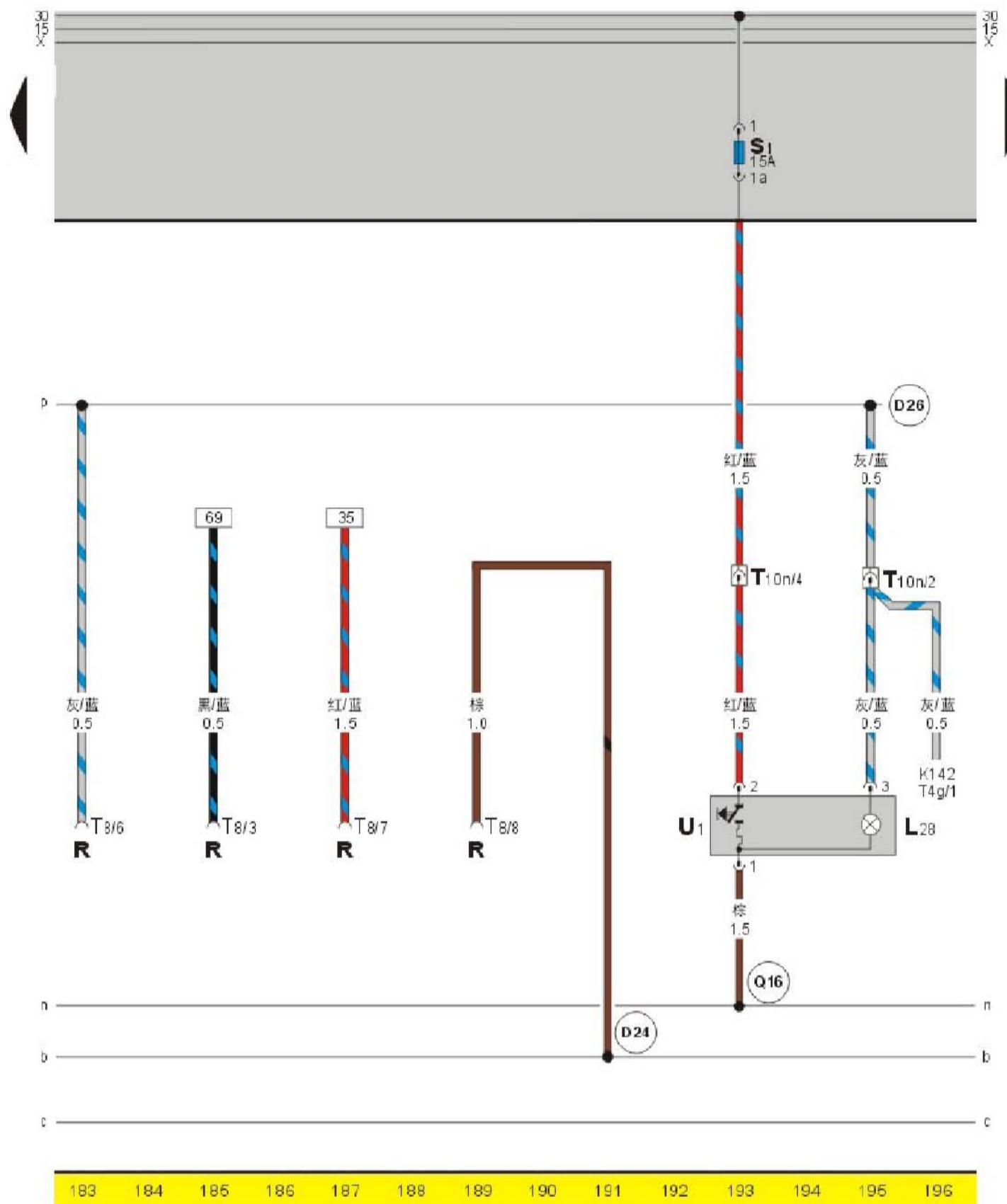
K142 — 换挡操纵杆 P/N 警告灯, 在换挡盖板上
