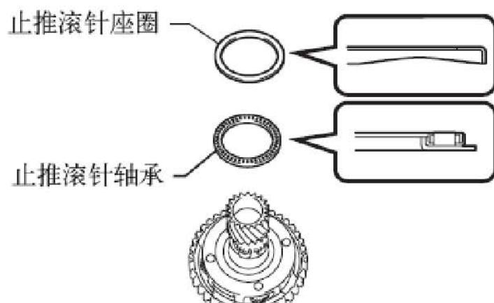
C). 将3号制动器毂安装到低速档行星齿轮总成上。
