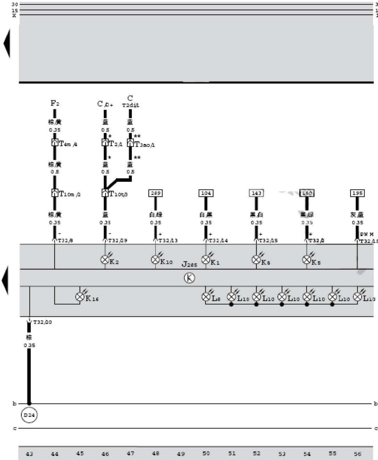
组合仪表控制单元、充电不足警告灯、驾驶员侧开门报警灯、转向指示灯、远光大灯的指示灯、后风窗除霜器开关的指示灯、仪表照明灯
