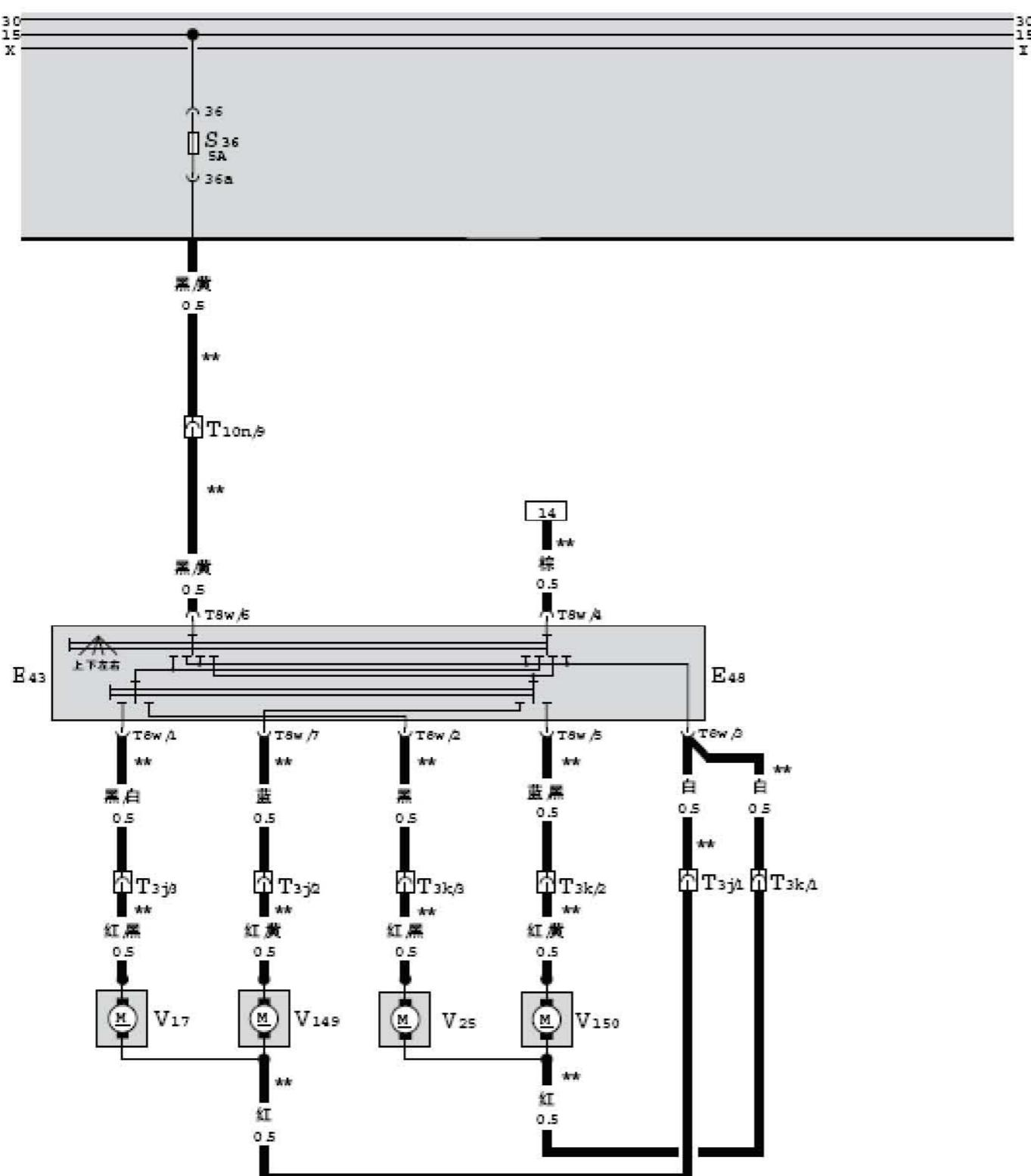
电动后视镜调节开关、电动后视镜转换开关、
