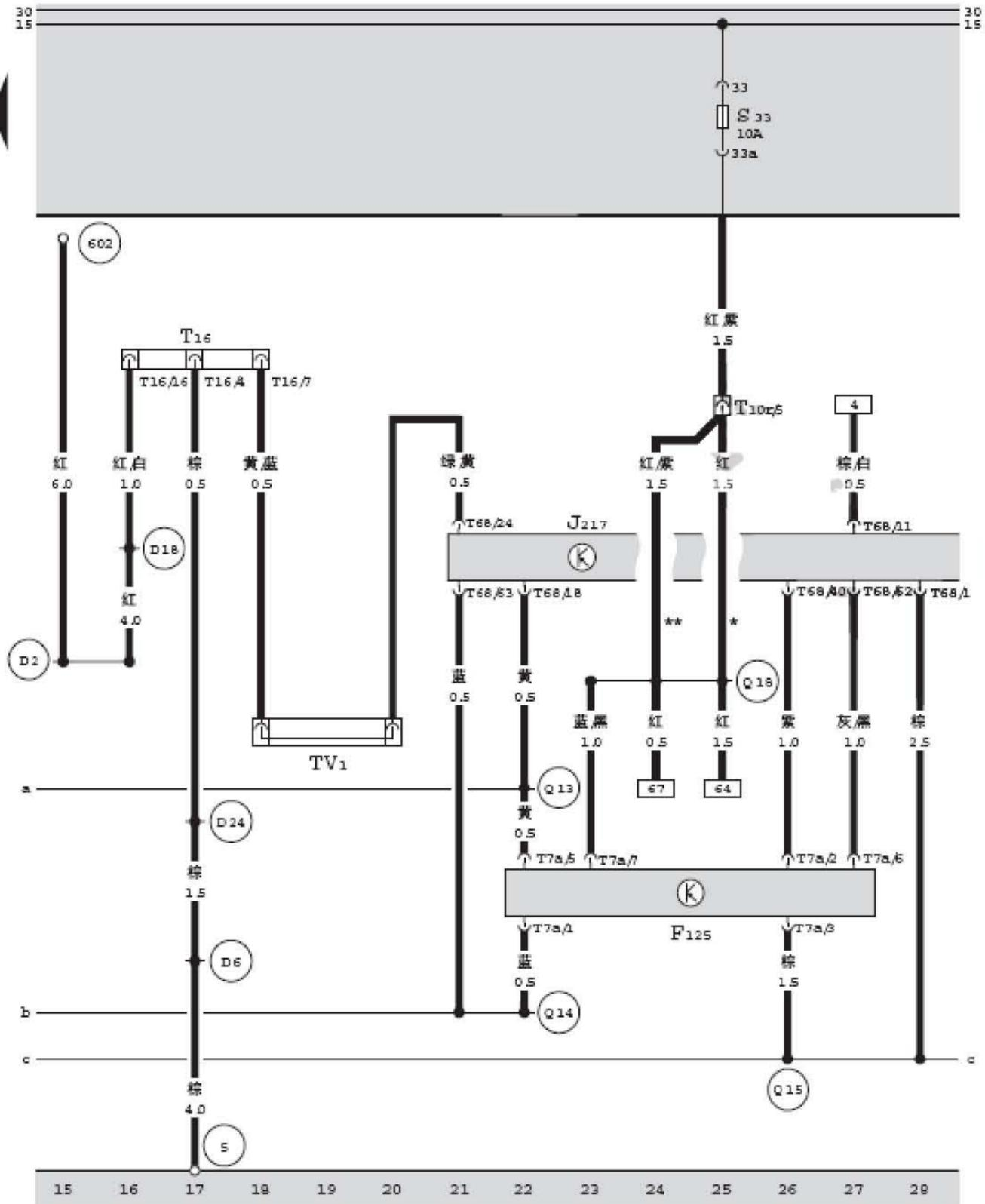
自动变速箱控制单元、多功能开关、自诊断接口、诊断线插座
