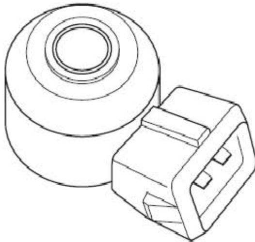
在气缸体后侧，3号和4号缸之间安装了一个压电陶瓷的爆震传感器，通过连接器EM021 与发动机线束连接。
