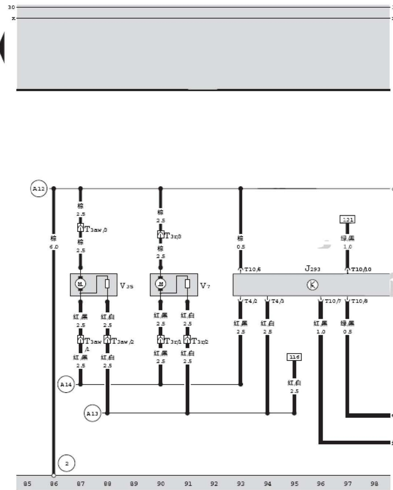
冷却液风扇控制单元、左散热风扇、右侧冷却液风扇
