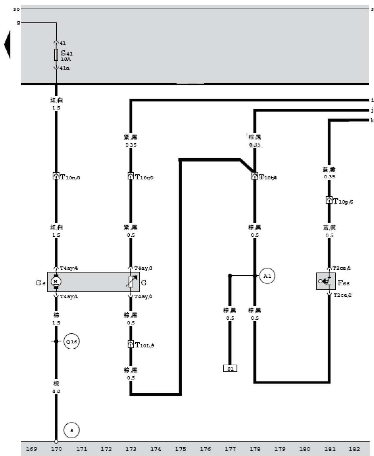
燃油表传感器、燃油泵、冷却液不足显示开关
