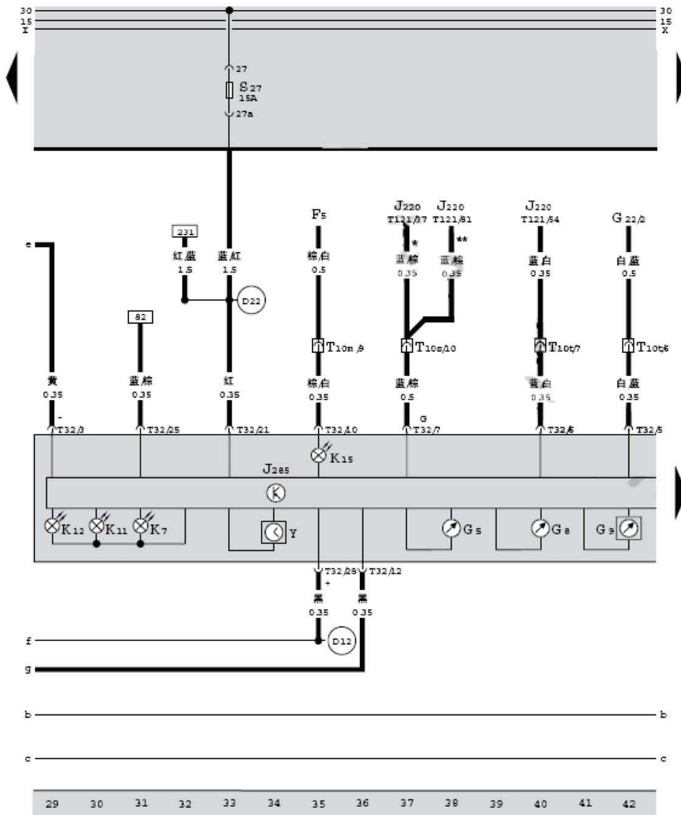
组合仪表控制单元、转速表、车速里程表、数字计程表、油压报警灯、行李箱开门警告灯、手制动指示及制动液液位警告灯、数字钟
