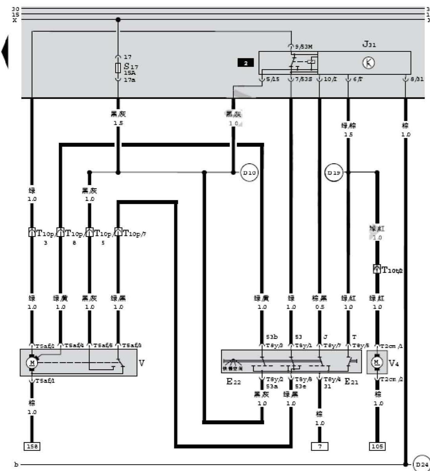
前风窗清洗泵、前风窗刮水器电机、前风窗清洗泵开关、前风窗刮水器开关、刮水器继电器
