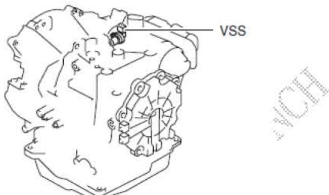
D). 测量VSS 连接器A 端 (线束侧) 处的电压。
