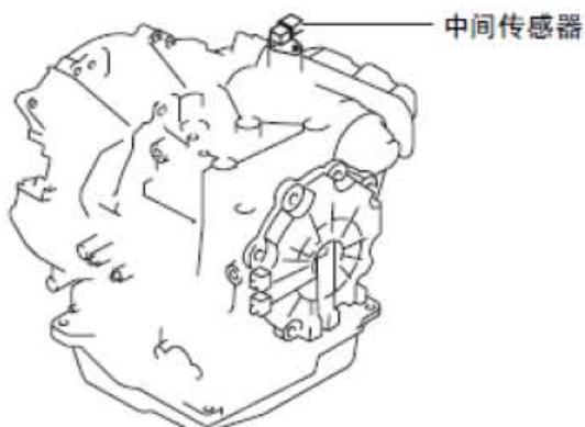
D). 测量中间传感器接线端A（线束侧）处的电压。
