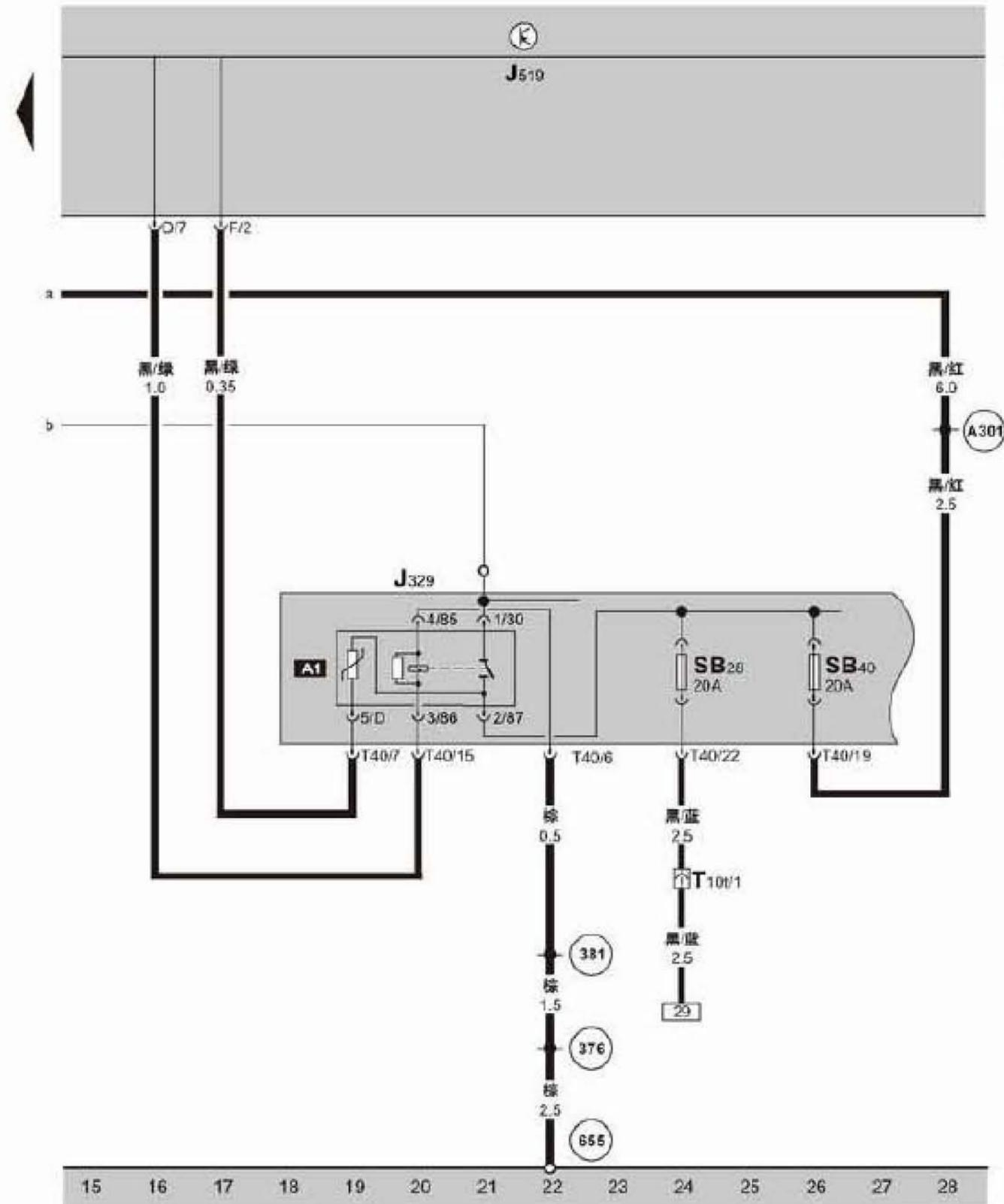
J329 — 总线端 15 供电继电器，在发动机舱内左侧电控箱
