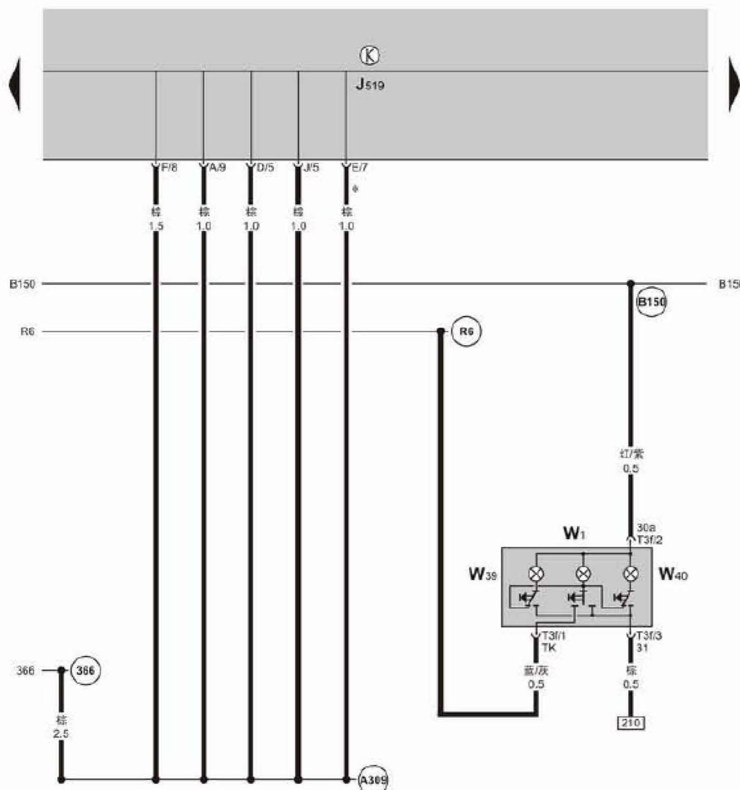
J519 — 车载网络控制单元，在仪表板左侧下方
