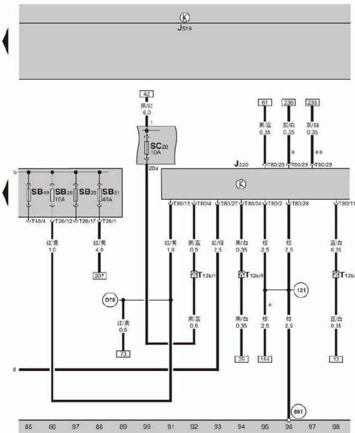
J220 — Motronic 控制单元, 在发动机舱横隔板中间后面
