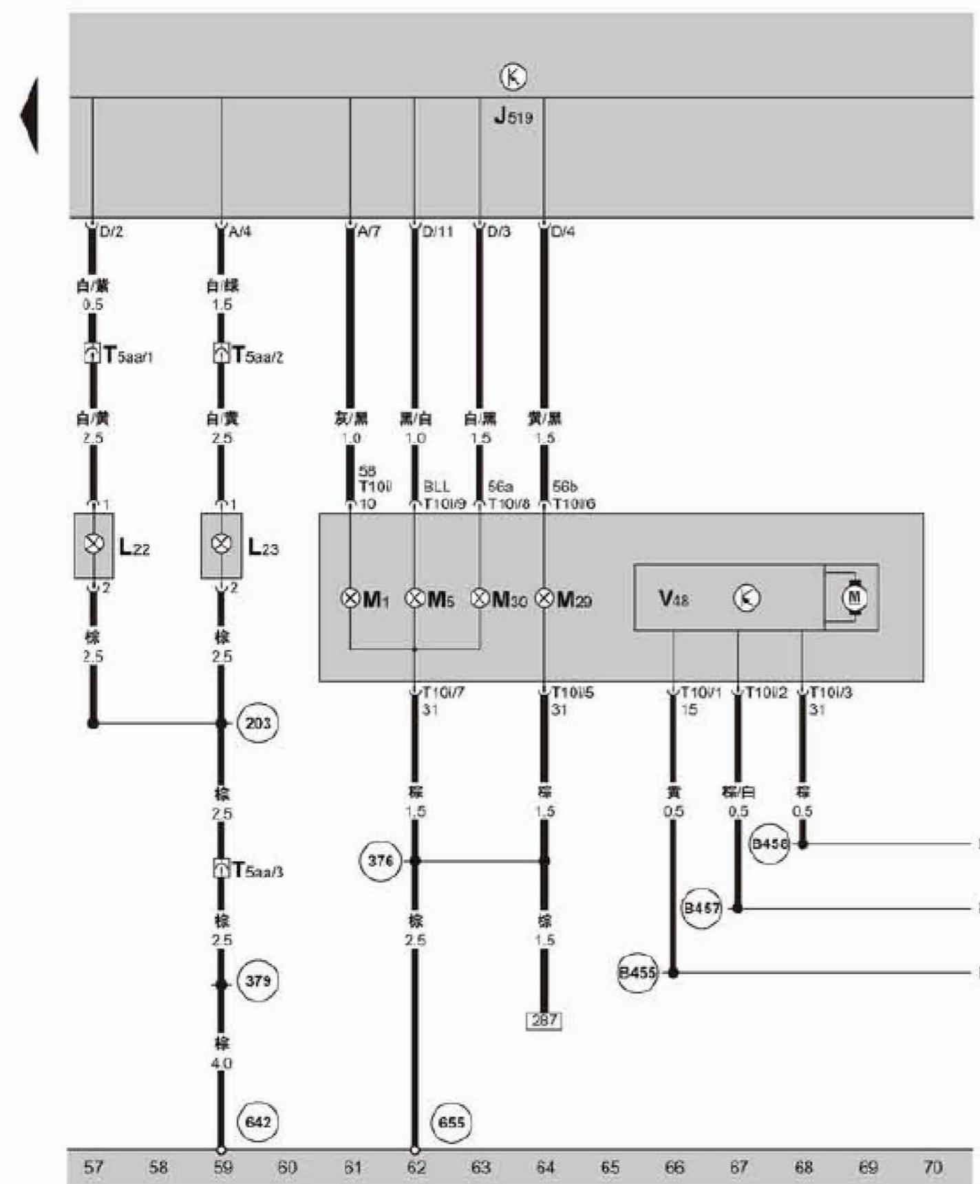
车载网络控制单元、左侧远近光灯灯泡、
