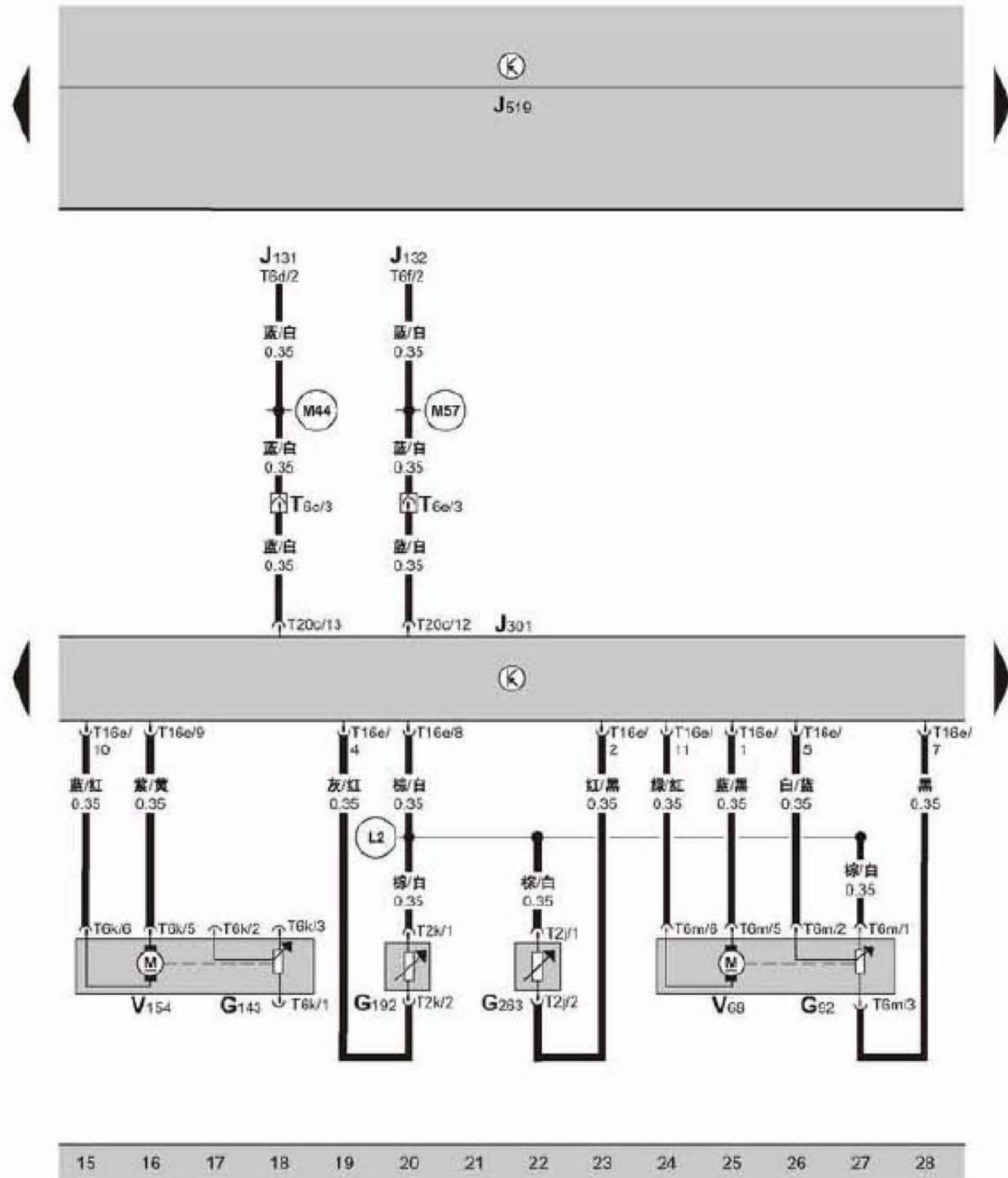
空调器控制单元、温度风门伺服马达、新鲜空气 / 空气内循环风门伺服马达、脚部空间出风口温度传感器、蒸发器出风口温度传感器、空气内循环风门伺服马达内的电位计、电位计 - 温度风门伺服马达
