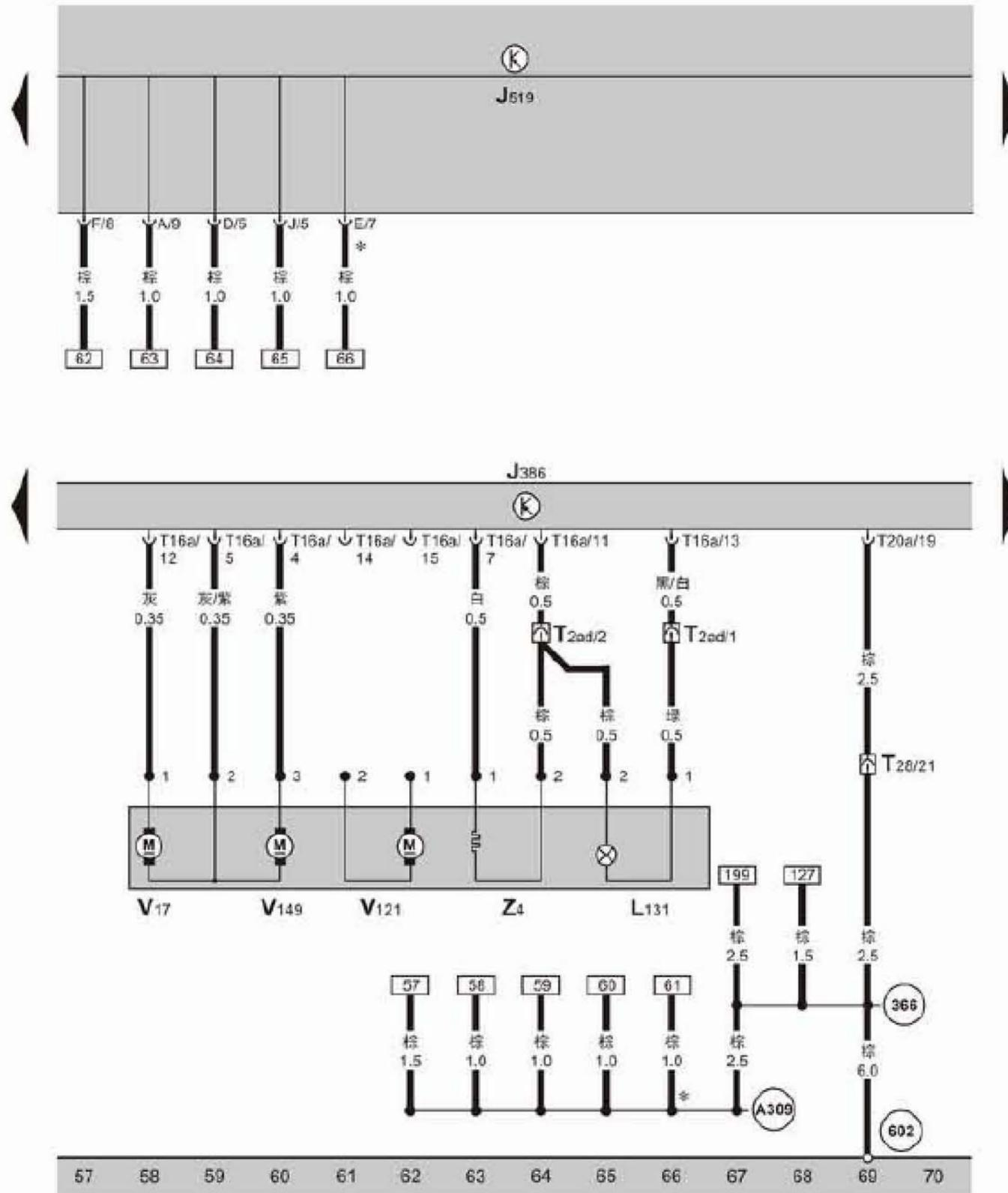
车载网络控制单元、驾驶员侧车门控制单元、后视镜调节马达(驾驶员侧)、后视镜折叠马达(驾驶员侧)、车外后视镜加热装置, 驾驶员侧
