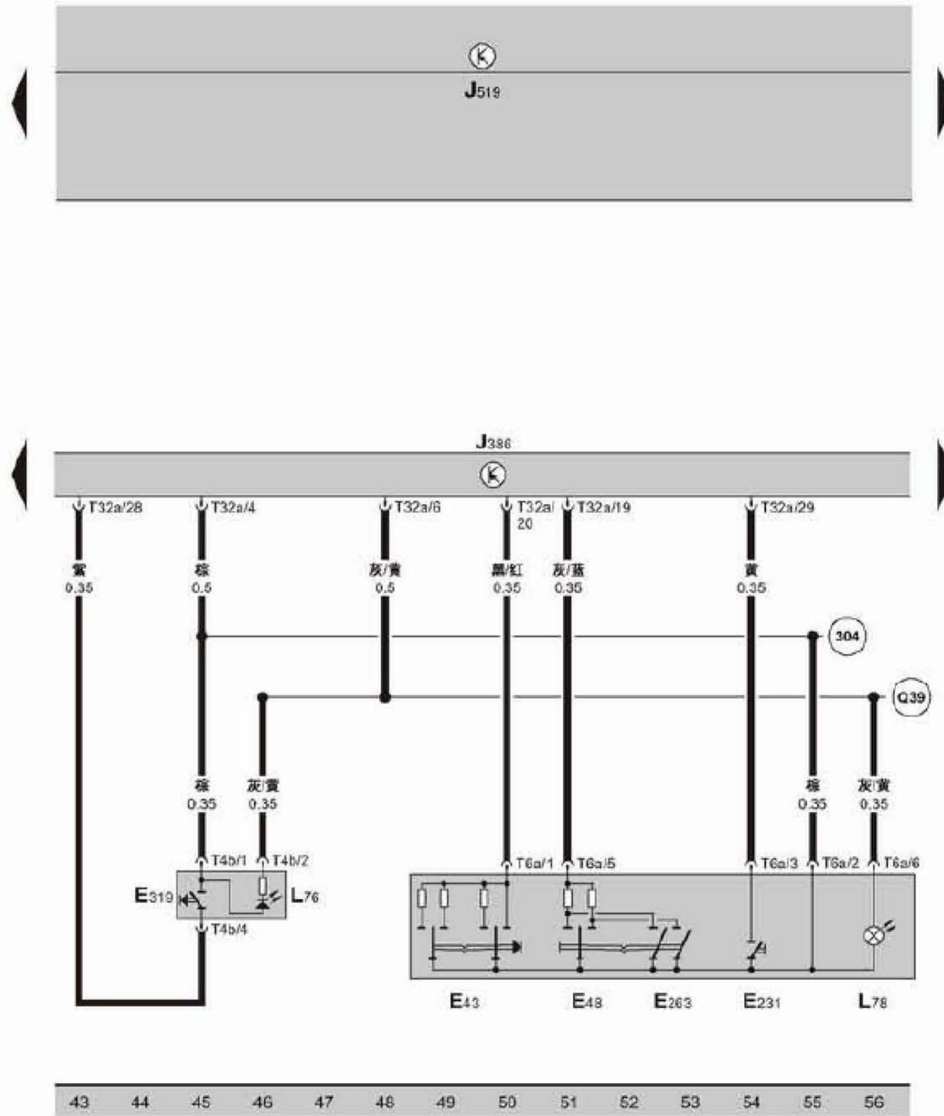
驾驶员侧车门控制单元、燃油箱盖开锁按钮、后视镜调节开关、后视镜调节转换开关、后视镜内折开关、车外后视镜加热按钮
