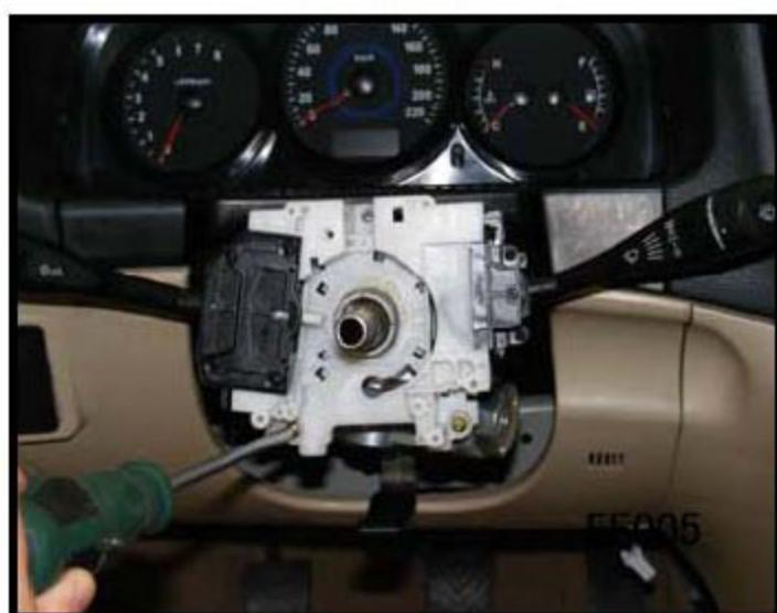
7).拆下安装螺栓，从转向管柱中分离点火开关。
