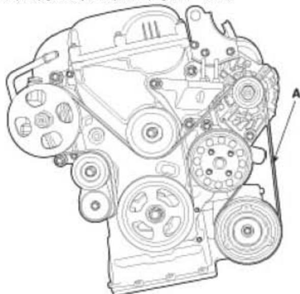
通过逆时针转动自动张紧器拆卸驱动皮带。
