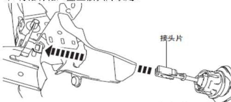
2). 按所示的箭头旋转离合器主缸直至无法再旋转为止。
