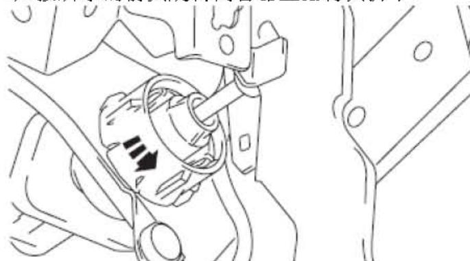
2). 使用平头螺丝刀压下推杆左右两侧的接头片，然后拆下推杆。
