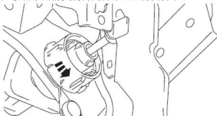
2). 使用平头螺丝刀压下推杆左右两侧的接头片，然后拆下推杆。
