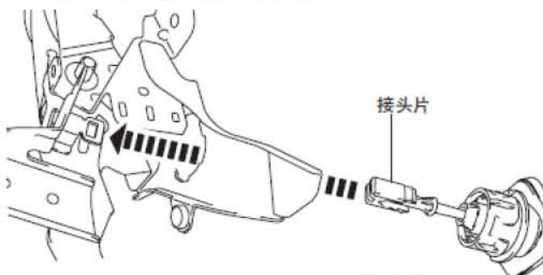
2). 按所示的箭头旋转离合器主缸直至无法再旋转为止。
