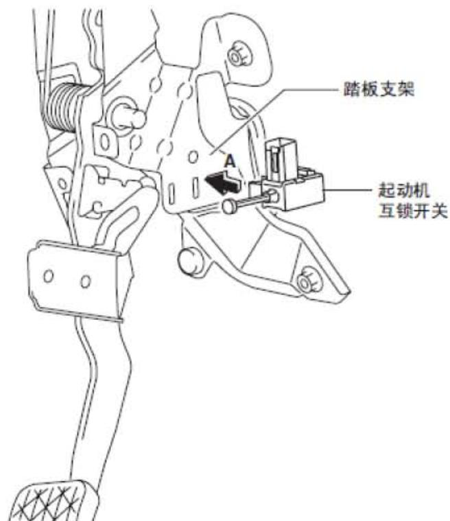
2). 滑动起动互锁开关，将其推向箭头B 所指方向，直到它被锁住为止。
