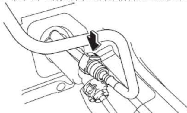
2). 将离合器主缸卡箍拉至如图所示的位置并直接拉出离合器油管连接器使其分离。
