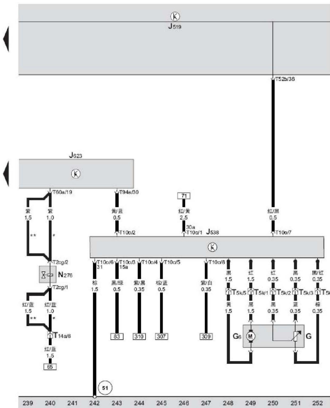
BCM 车身控制单元、发动机控制单元、燃油泵控制单元、燃油压力调节阀、燃油存量传感器、燃油泵(供油泵)
