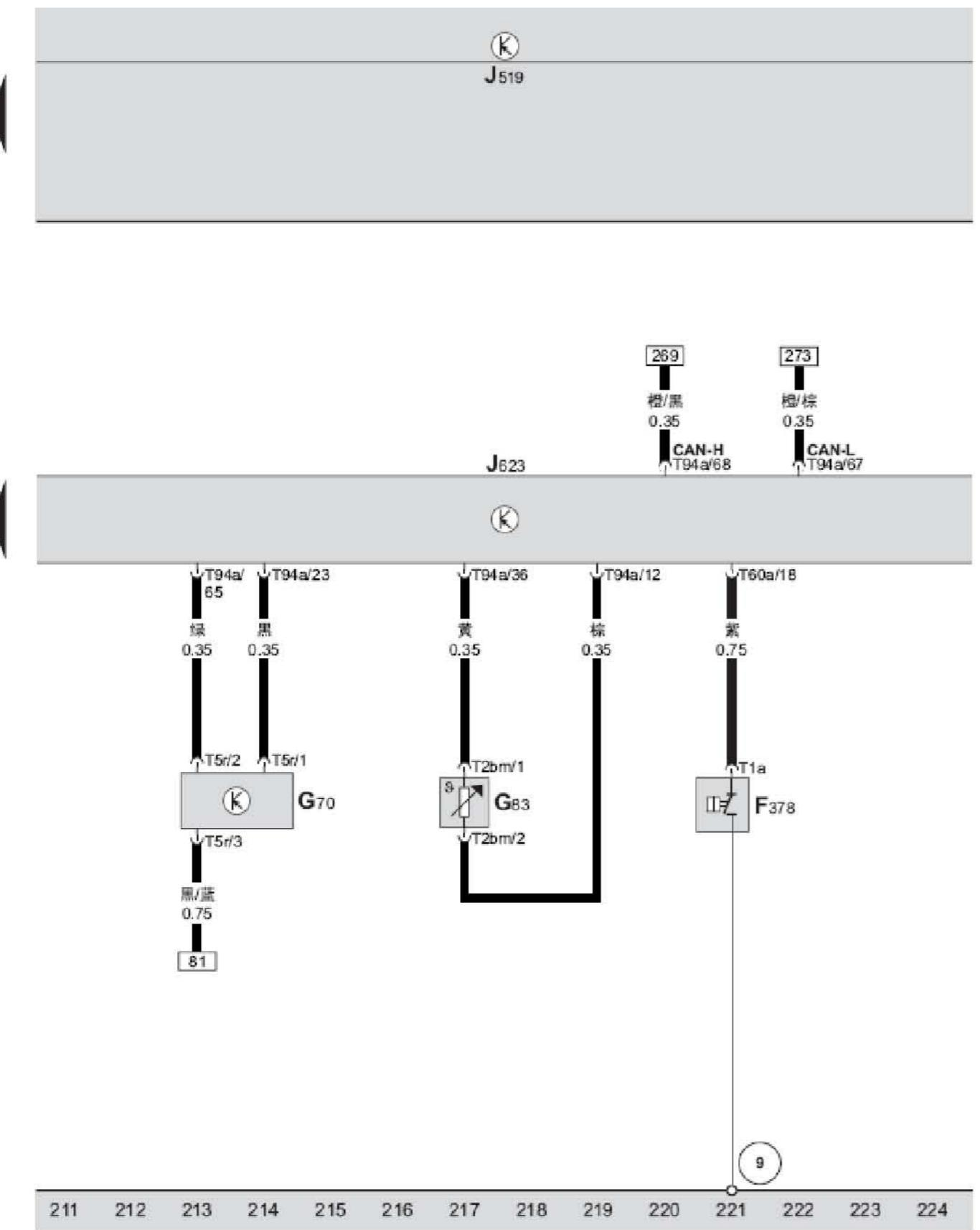
发动机控制单元、水箱出口冷却液温度传感器、空气质量计、机油压力防降开关
