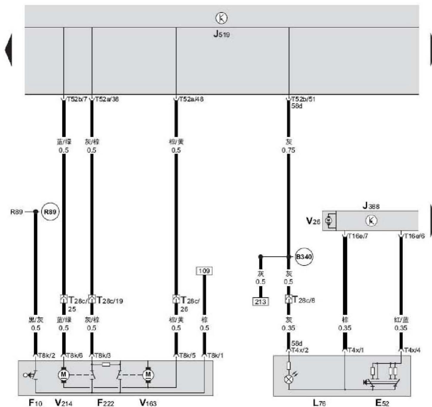
BCM 车身控制单元、左后车门控制单元、左后车窗升降器开关、左后车门接触开关、左后中央门锁闭锁单元、左后车窗升降器马达、按钮照明、左后车门中央门锁马达
