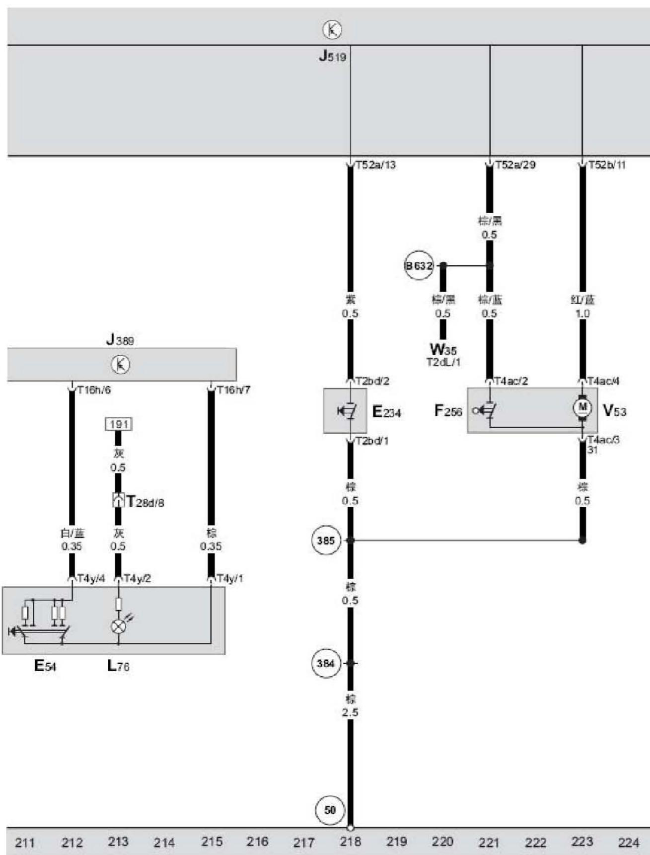
BCM 车身控制单元、右后车门控制单元、右后车窗升降器开关、后行李箱盖把手开锁按钮、后行李箱盖中央门锁马达、按钮照明、后行李箱盖闭锁单元
