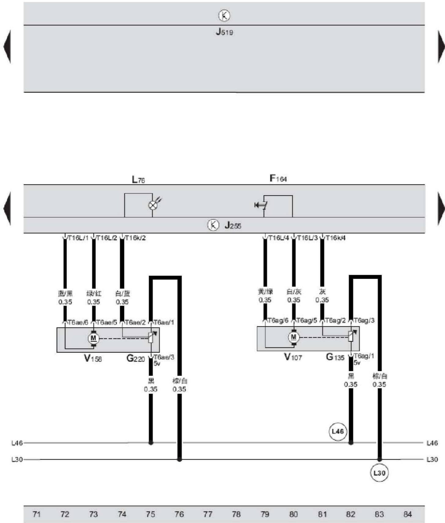
Climatronic 控制单元、除霜运行开关、除霜风门伺服马达内的电位计、左侧温度风门伺服马达、除霜风门伺服马达、左侧温度风门伺服马达的电位计、按钮照明
