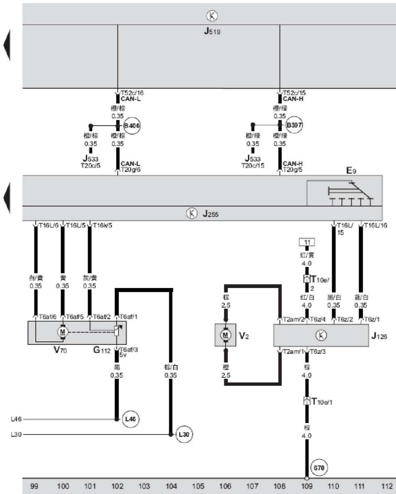
BCM 车身控制单元、新鲜空气鼓风机控制单元、Climatronic 控制单元、中央风门伺服马达内的电位计、新鲜空气鼓风机开关、新鲜空气鼓风机中央风门伺服马达
