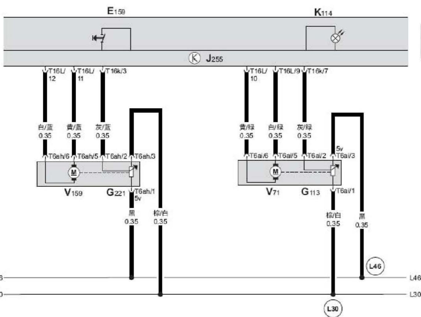
Climatronic 控制单元、速滞压力风门伺服马达、右侧温度风门伺服马达、速滞压力风门伺服马达内的电位计、右侧温度风门伺服马达的电位计、新鲜空气和空气内循环风门开关、新鲜空气和循环空气运行模式指示灯
