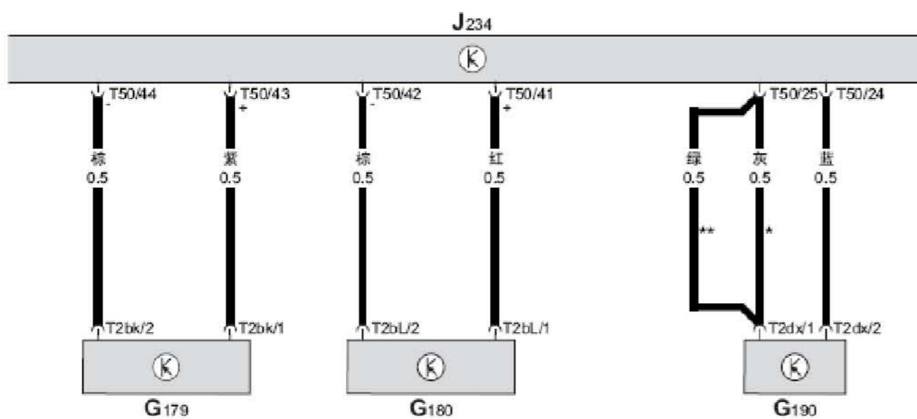
G179 — 驾驶员侧侧面安全气囊碰撞传感器，在左 B 柱下方
