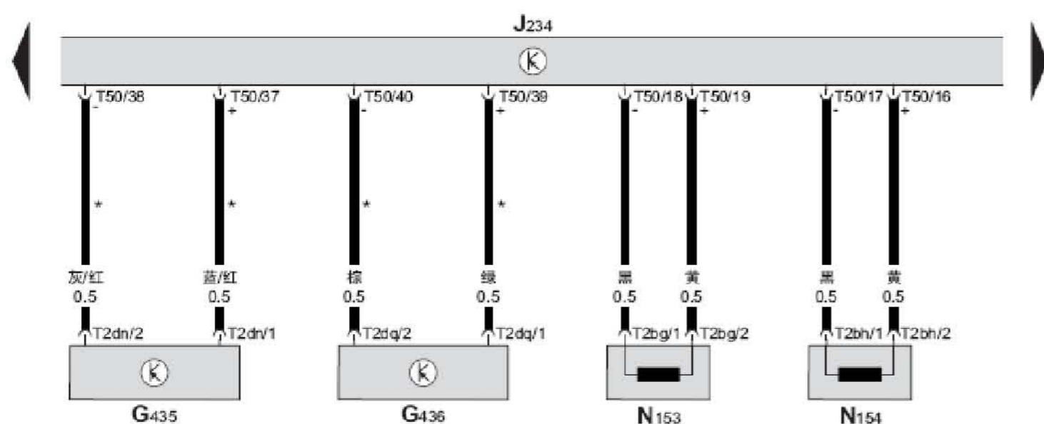
G435 — 驾驶员侧头部安全气囊碰撞传感器，在后座垫左侧
