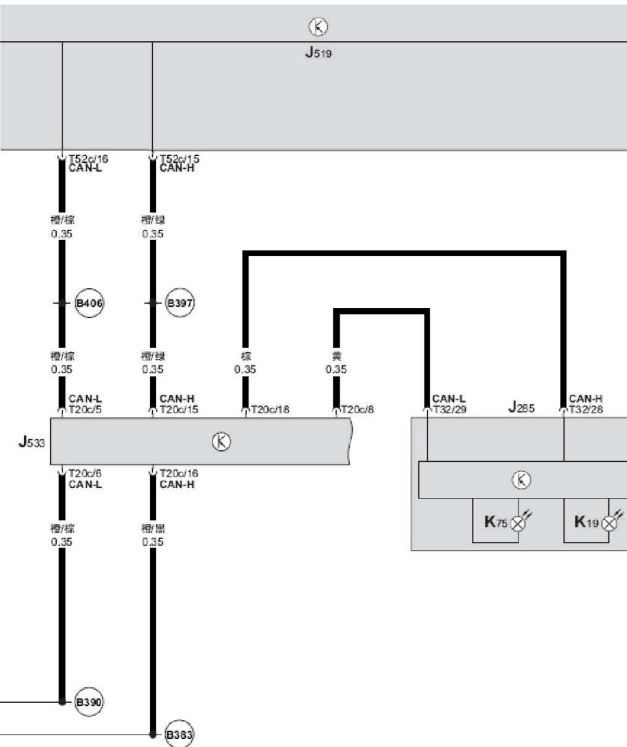
BCM 车身控制单元、组合仪表中带显示单元的控制单元、数据总线诊断接口、安全带报警系统指示灯、安全气囊指示灯
