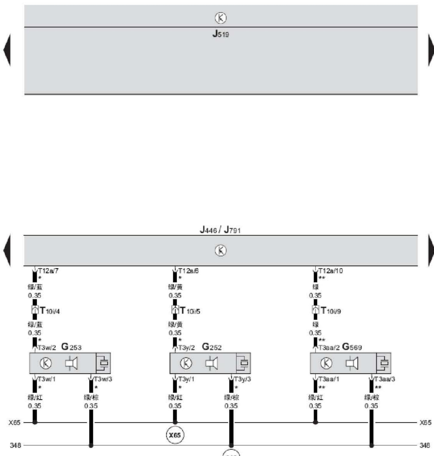
驻车辅助控制单元、驻车辅助和驻车转向辅助
