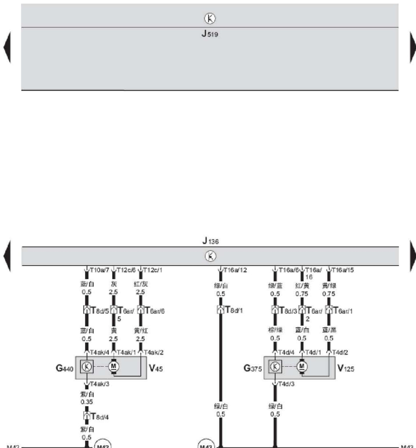
带记忆的驾驶员座椅调整控制单元、腰部支撑纵向调节传感器、靠背调节传感器、驾驶员座椅靠背调节马达、驾驶员座椅腰部支撑纵向调节马达
