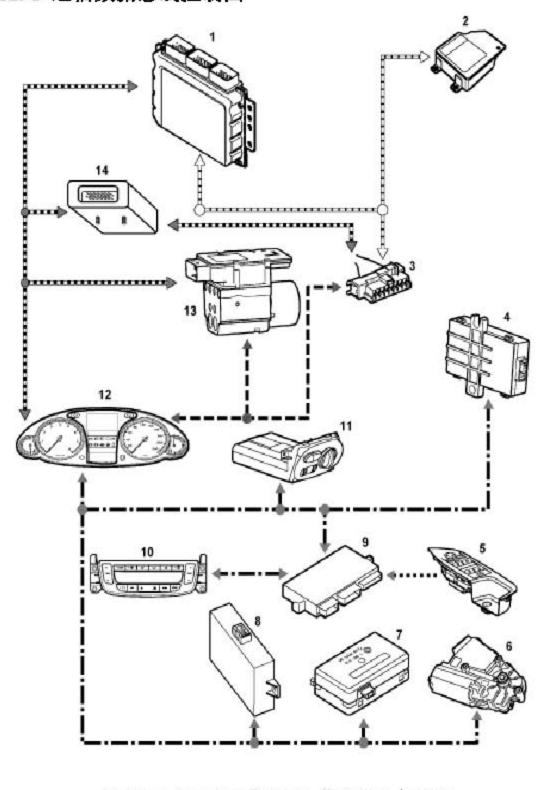
B=K 总线;C= 诊断总线;D=CAN 总线; H= 驾驶员侧门组合开关总线;J=ISO9141-2K 诊断总线
