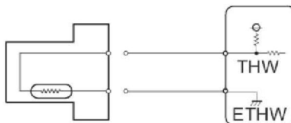
正常：更换发动机冷却液温度传感器
