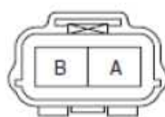
输入/涡轮转速传感器 线束侧连接器
