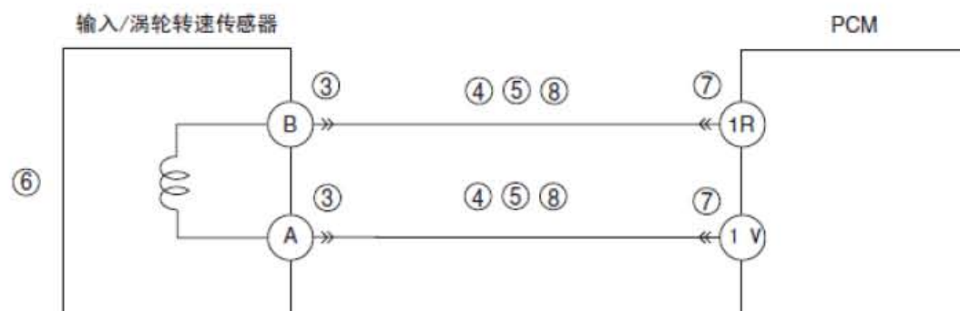
输入/涡轮转速传感器 线束侧连接器
