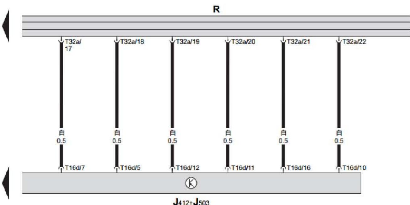
收音机、天线放大器、导航系统( GPS )天线、收音机/电话天线
