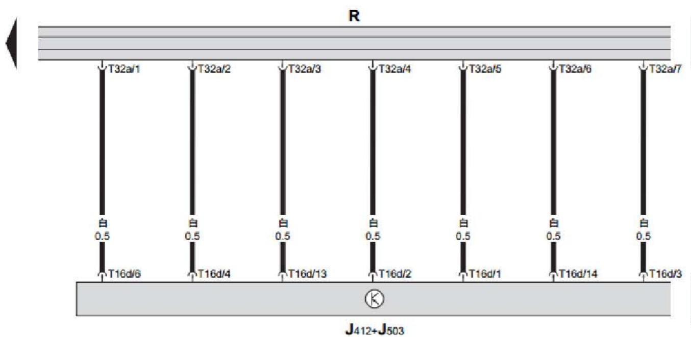
收音机、移动电话电子操作装置控制单元、收音机和导航系统的带显示单元的控制单元
