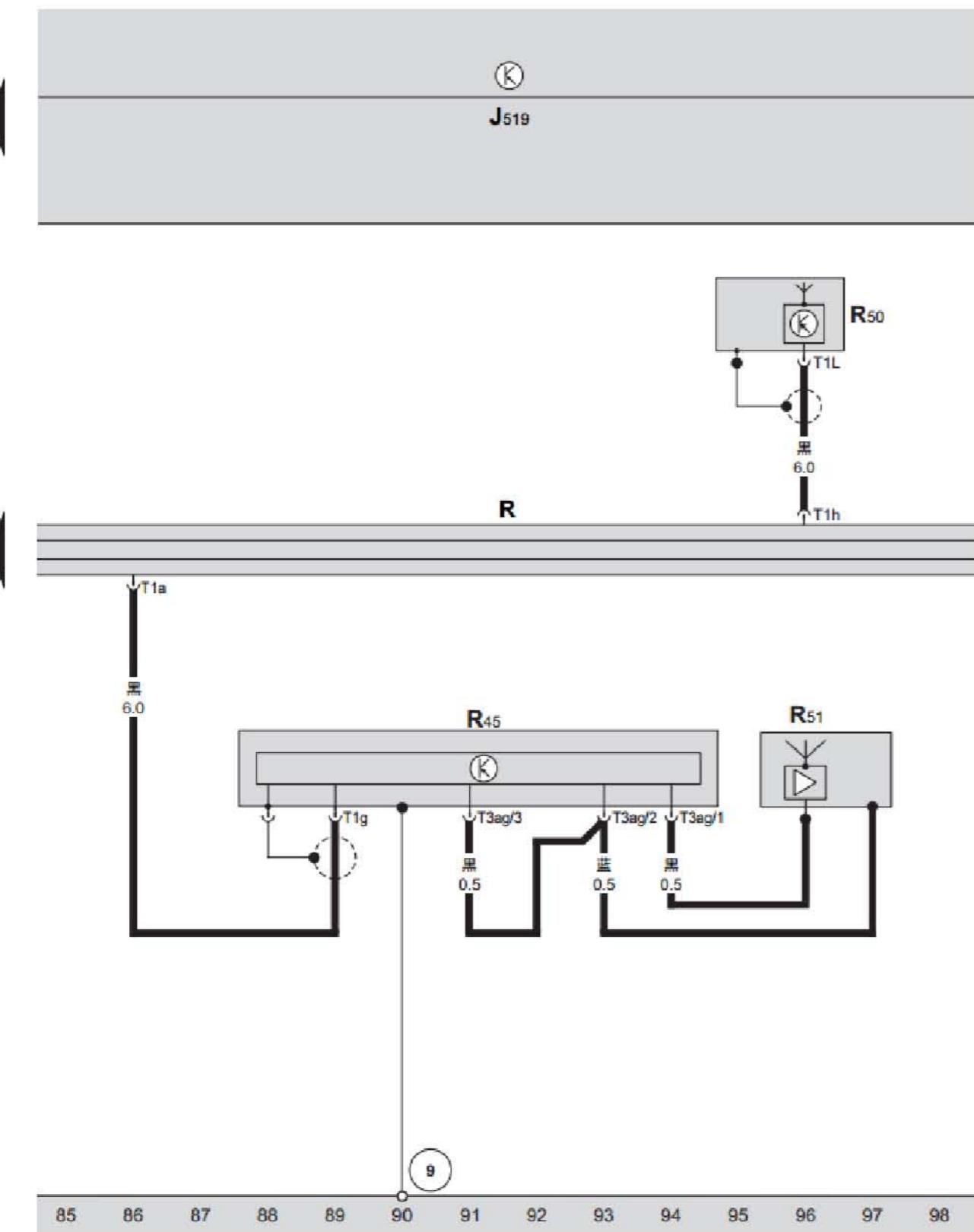
收音机、天线放大器、导航系统( GPS )天线、
