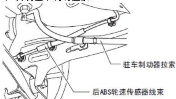
3). 按图示检查驻车制动拉索外端的末端是否在制动钳外。
