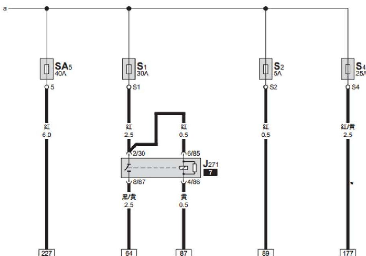
J271 — Motronic 供电继电器, 在仪表板左侧下方继电器支架上 7 号位 (643 继电器)
