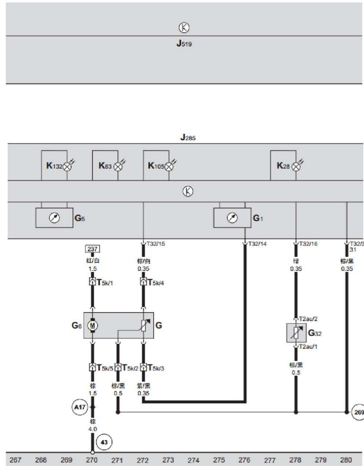
组合仪表中带显示单元的控制单元、燃油储备显示、转速表、排气警示灯、电控节气门故障信号灯、冷却液不足显示传感器、冷却液温度 / 冷却液不足显示指示灯、燃油存量传感器、燃油泵(供油泵)、燃油存量指示灯
