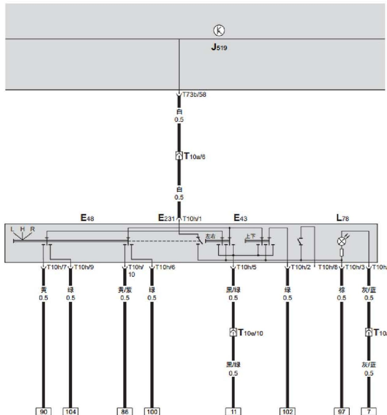
**BCM 车身控制器、后视镜调节开关、后视镜调节转换开关、车外后视镜加热按钮、后视镜调节开关照明**
