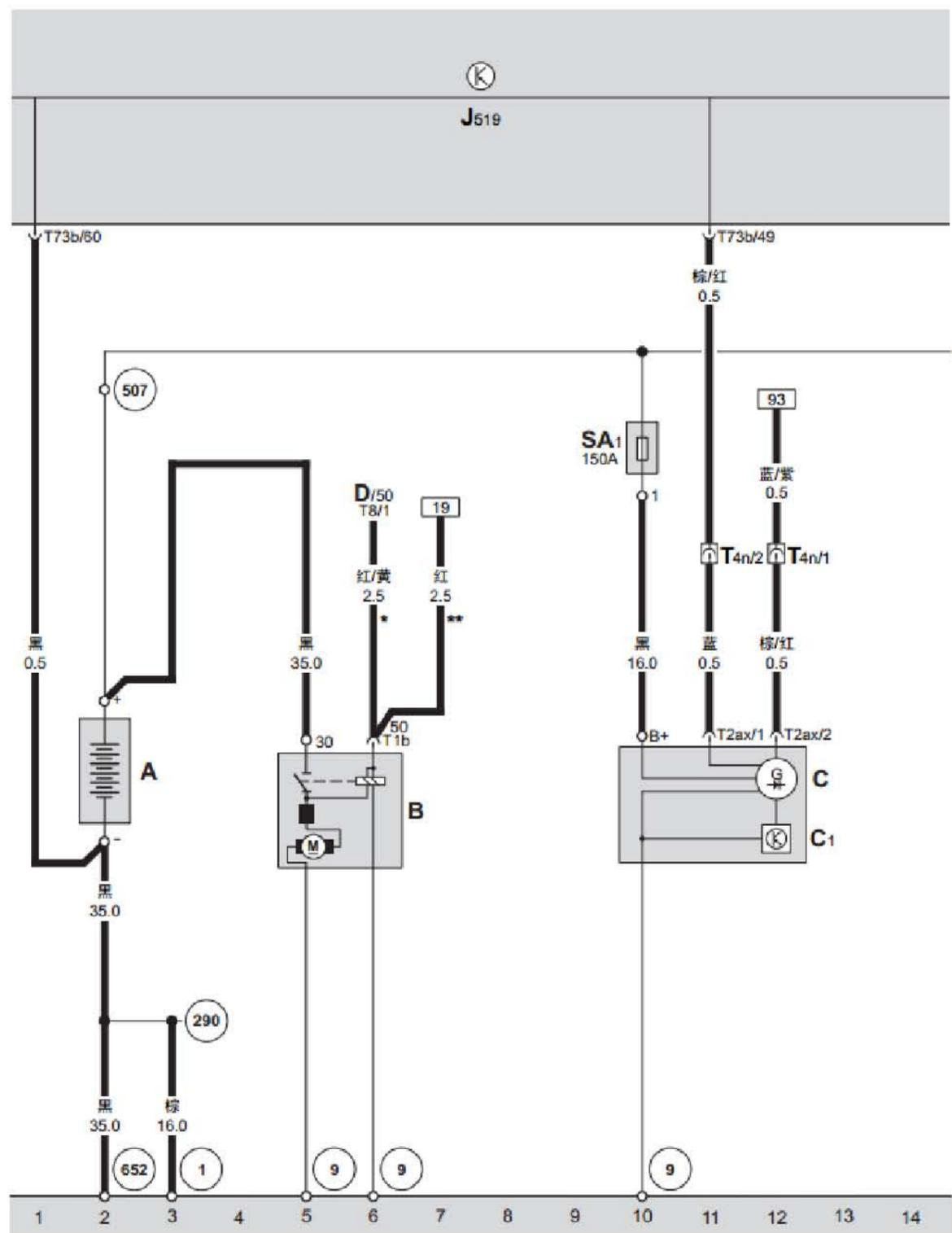
BCM 车身控制器、蓄电池、起动马达、交流发电机、电压调节器
